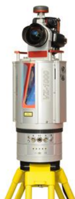
照片一：左圖為 Riegl VZ-1000 設備，右圖為來社溪執行之工作照。
