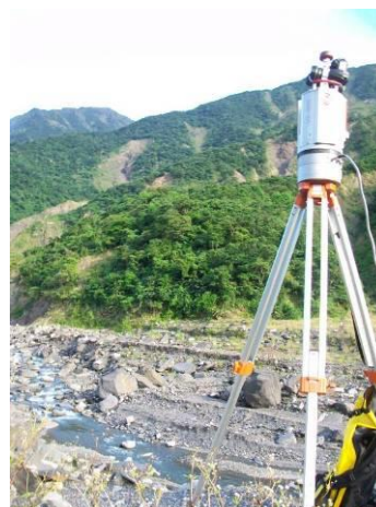
照片一：左圖為 Riegl VZ-1000 設備，右圖為來社溪執行之工作照。
