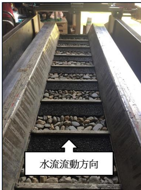
圖 1 固床工下游設置粗拋石及固床工間距二分之一長度的鋪設情形
