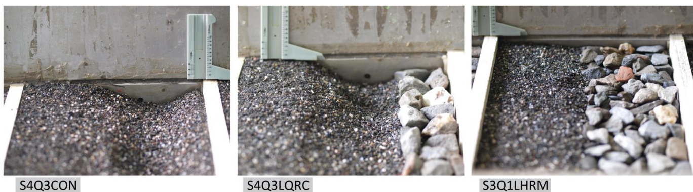
圖 4 固床工下游之局部冲刷 (S3 : 坡降=0.066; S4 : 坡降=0.085; Q1 : 流量=0.00058 cms; Q3 : 流量=0.00093 cms; LQ : 拋石長度=0.05 m; LH : 拋石長度= 0.1 m; RM : 拋石粒徑=16.75 mm; RC : 拋石粒徑=21.77 mm;和 CON: 對照組)。
