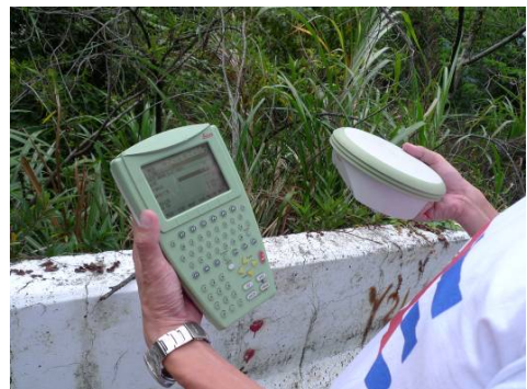
圖 7 高精度 GPS (型號: Leica ATX1230 GG)
