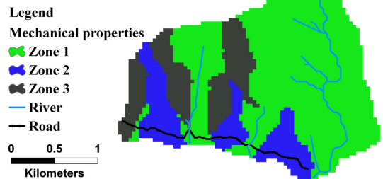
圖 7 地層強度參數分區 (區域 1、區域 2 和區域 3 的土壤凝聚力 (變異係數) 為 10 (30%)、13 (20%) 和 15 (10%)、土壤摩擦角 (變異係數) 為 30 (20%)、30 (15%)和 32 (10%)、土壤單位重為 20.1 kN/m 3 ) Fig.7 The assumption of the strength parameters of the study zones
