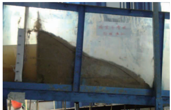
圖 12 平推式滑坡物理類比試驗
