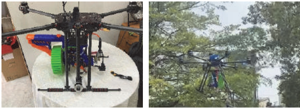
圖 4 裝配完成的噴植物種植無人機，並進行了飛行測試
