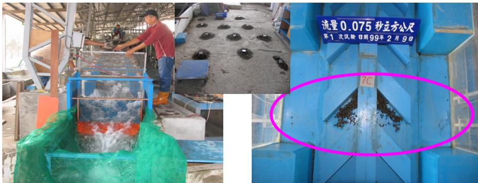
照片 2 流量 0.075 時分段收砂完成情形、試驗後殘留於 C 斷面情形
