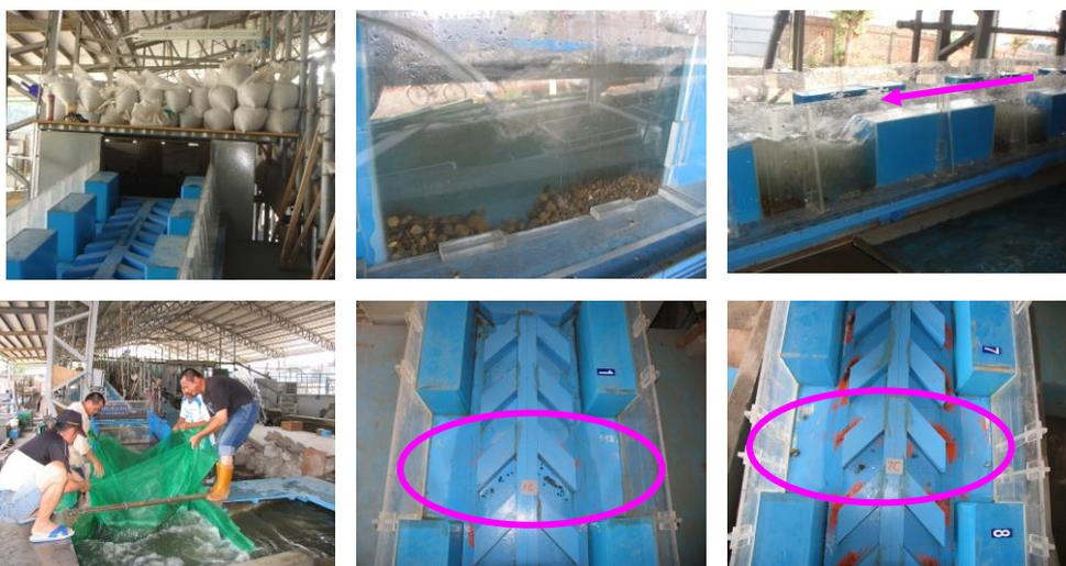
照片 4 加砂預備及分段收砂、試驗中砂石暫留、少部分殘留於 C 斷面情形
