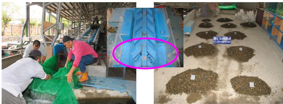
照片 3 流量 0.1 時分段收砂情形、試驗後殘留於 C 斷面情形、分段收砂完成情形
