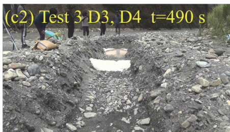
圖 8 Test 3 雙壩試驗 (D3,D4); D3 潰決 (2023/8/31)
