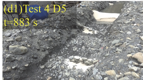
圖 11 Test 4 D5 滲流破壞 (2023/8/31)
