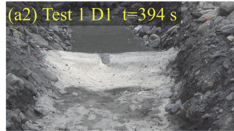
圖 4 Test 1 D1 單壩溢頂 (2023/8/30)
