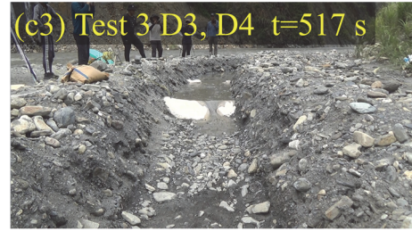
圖 9 Test 3 雙壩試驗 (D3, D4); D4 潰決 (2023/8/31)
