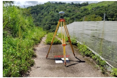
圖 6 VBS-RTK 定位測量現場作業
